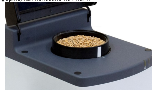
Рис. 4 Кювета с образцом установлена на платформу
